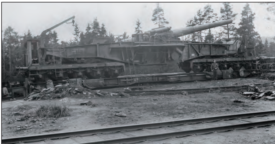
28 cm jernbanekanon på Knatterud, etter kapitulasjonen i 1945. Kanonen var 22,8 meter lang og veide 118 tonn. Lengden på kanonrøret var 11,93 meter og skuddhastigheten var ca 10 skudd i timen. Dreiebanen (skinnebanen) hadde en diameter på 22 m. I forgrunnen ser vi jernbanespor til Sarpsborg. Fotograf: Ukjent Eier: Rolf Borge, Råde som vi også ser på bildet.
